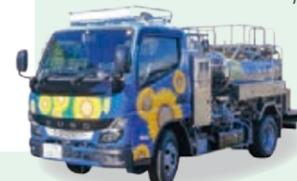
高さ25mの高所まで給水できる加圧ポンプを装備した給水タンク車を配備
