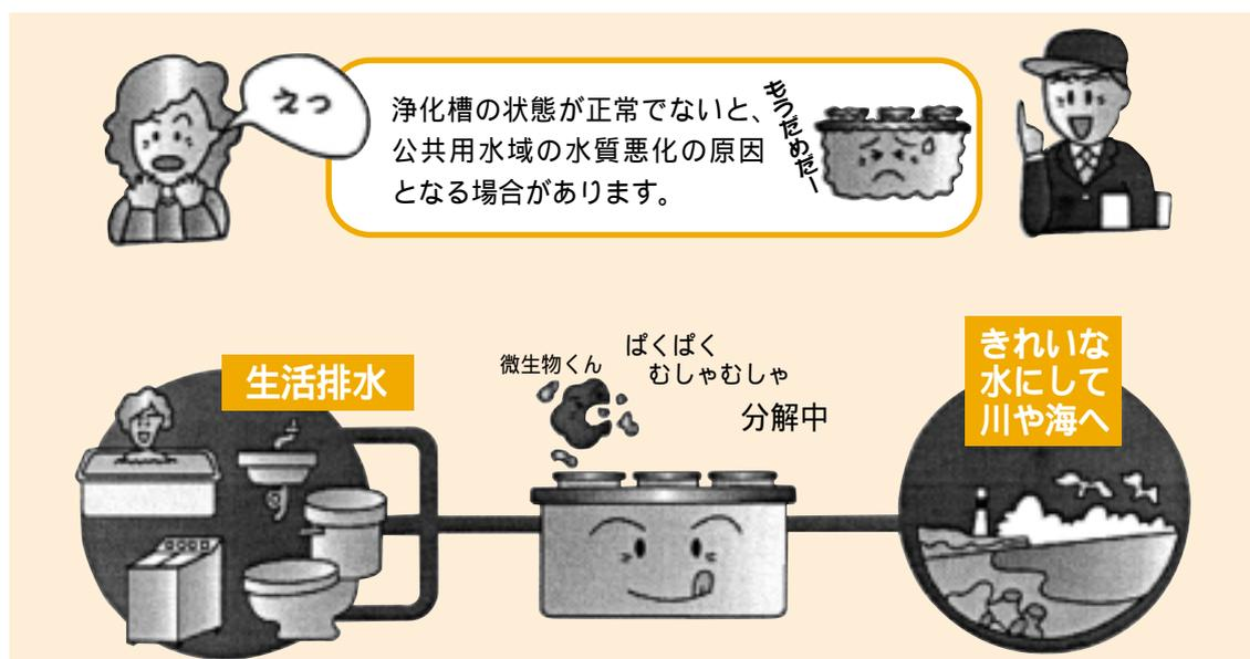
浄化槽は微生物の働きで水をきれいにしています。この生き物が元気に働くよう定期的な点検・清掃はもちろん、適正に管理されていることを公的に確認する法定検査も併せて受けましょう。
