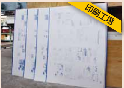
③刷版づくり 印刷機に巻きつけ、印刷する部分にのみインキが付着するように加工した金属板。4色(黒青赤黄)分。
