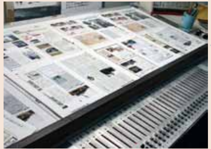
⑥仕上がりチェック カラーの色合いなどをチェック。下に見えるボタンを押すことで、インクの量を調節します。
