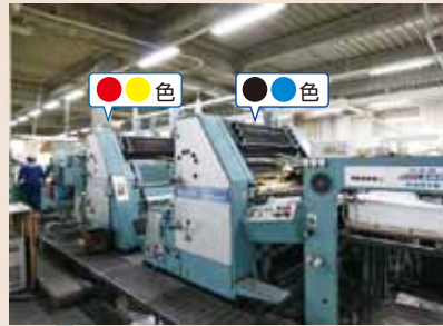
④印刷(その1) 4色分の刷版を印刷機にセット。紙は、4種類の刷版の上を順に通ります。
