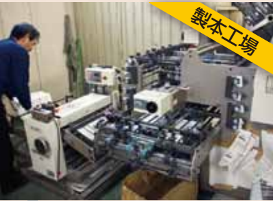
⑧折る 印刷完了した大きな用紙を、紙折り機でA4サイズに折ります。
