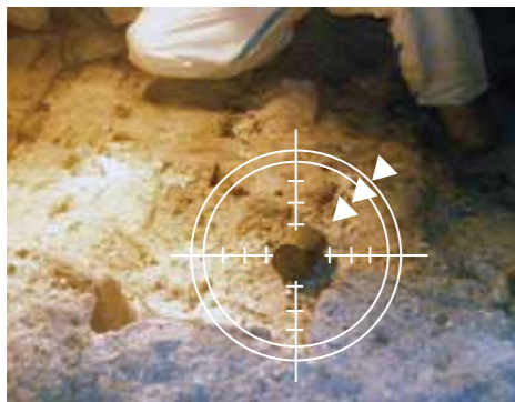
焼却炉の空気の吸い込み口をふさいでいたスチール缶
