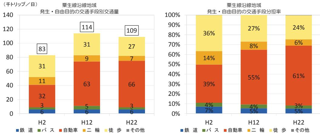
図2-12 粟生線沿線地域の発生・自由目的の交通手段（左交通量・右分担率）（出典：PT調査）
