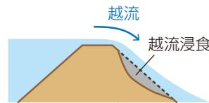
豪雨や洪水吐の閉塞により、貯水位が急激に上昇し、堤体を超えて流れ出すと、下流法面を侵食することによって、破壊する場合があります。また、貯水位の上昇により、堤体内の水圧も上昇し、強度が低下して破壊する場合があります。
