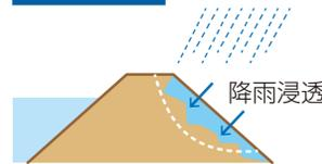
貯留した水と降雨が堤体の中に浸透して、堤体内部の水分量が増加し、堤体の法面の強度が低下することによって、法面部ですべりが発生し破壊する場合があります。
