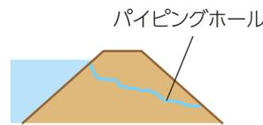
堤体内部が劣化して、水を遮る機能が低下すると、貯水位が上昇したときに堤体の中の水圧も上昇して強度が低下し、破壊する場合があります。また堤体内に上流から下流まで貫通した水みちが発生し破壊する場合があります。
