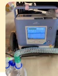
加温加湿器・人工呼吸器
